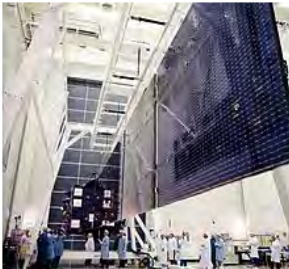
Les panneaux solaires qui portent l'envergure de Rosetta à 32 mètres constituent la caractéristique externe la plus marquante de la sonde spatiale
