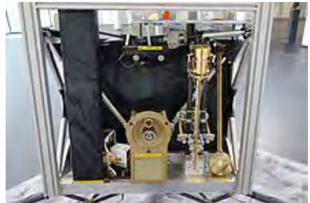
Les instruments CIVA, SD2, ROMAP, MUPUS ainsi que le système de largage sont visibles sur cette maquette de Philae
