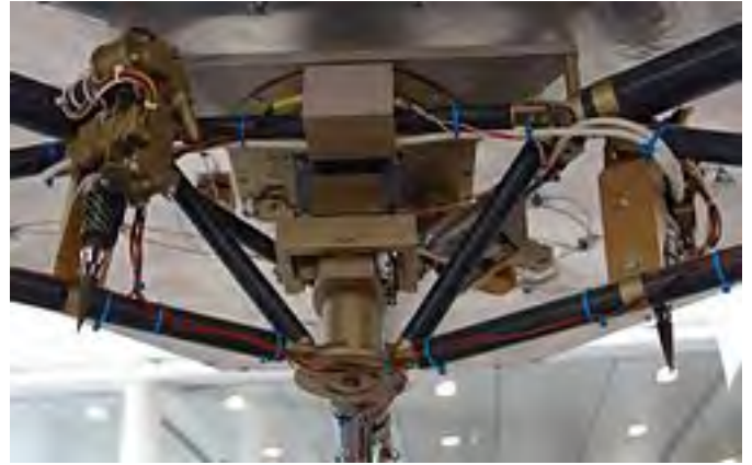
Deux harpons destinés à fixer l'atterrisseur sur le sol de la comète sont installés sous l'atterrisseur
