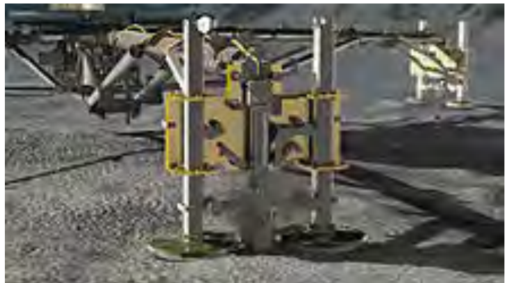
Chaque pied de Philae est muni de longues vis qui doivent s'enfoncer dans le sol pour empêcher l'atterrisseur de repartir dans l'espace
