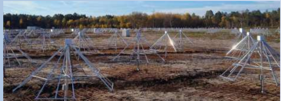
Radiotélescope NenuFar 1824 antennes Nançay
